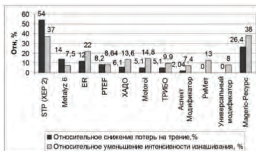
Рис. 3. Эффективность по снижению трения и изнашивания для типичных трибологических составов, распространенных на отечественном рынке присадок - добавок.
